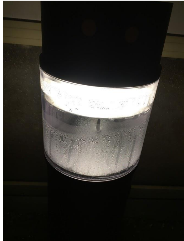
Kondensatbildung wegen fehlender Abwärme bei Einsatz einer handelsüblichen LED-Leuchte.
